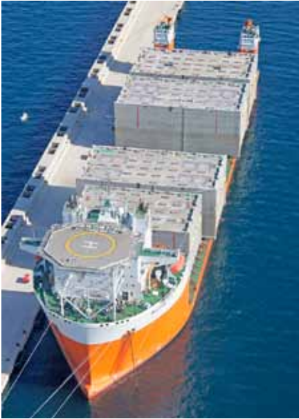
Estiba de cajones sobre barco semi sumergible para su traslado a Brasil.
